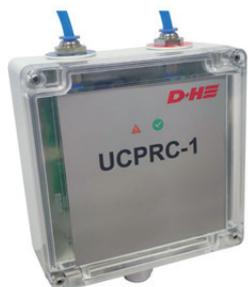
UCPRC-1 je univerzální snímač diferenčního tlaku určený pro použití v kontrolních systémech v případě šíření kouře a tepla. Snímač má analogovou komunikaci 0-10 V, 4-20 mA a digitální komunikaci MODBUS RTU. UCPRC-1 spolupracuje s řídicí jednotkou TSZ-200.
